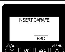
Odabran je postupak koji traži ispuštanje iz spremnika mlijeka. Uemtnite spremnik u aparat na način određen u priručniku.
