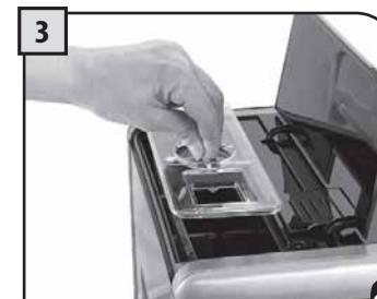
Otvorite vanjski lijevi poklopac i uklonite unutarnji poklopac.
