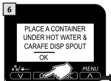
Jedan spremnik postavite ispod ispusta a drugi ispod cijevi s toploim vodom. Nakon toga pritisnite "OK".
