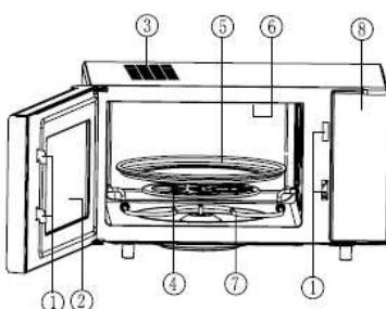
1. Bezpečnostný uzatvárací systém dverí
