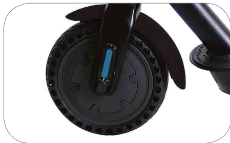
Pneus perforés sans chambre à air avec confort des pneus gonflables.
