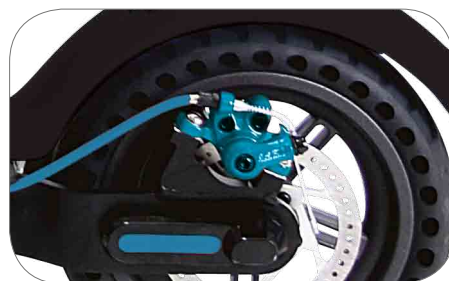
Zadní kotoučová elektronická brzda a odpružení zadního kola
