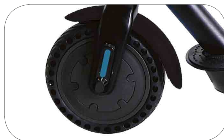
Perforované bezdušové pneumatiky s komfortem nafukovacích pneumatik.
