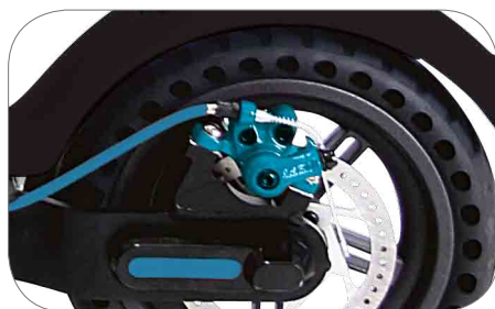
Freno a disco elettronico posteriore e l'ammortizzazione della ruota posteriore
