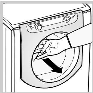
Na otevření dvířek s průzorem používejte vždy příslušné madlo (viz obrázek).
