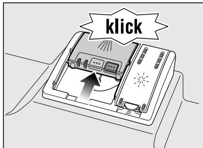
Komora pro mycí prostředek se v závislosti na programu automaticky otevře v optimální časový okamžik. Práškový nebo tekutý mycí prostředek se ve spotřebiči rozdělí a rozpustí, tableta spadne do záchytné misky na tablety a dávkovaně se zde rozpustí.
