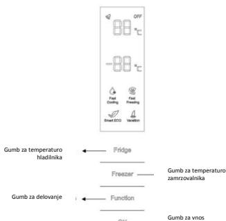
**NASTAVITEV TEMPERATURE:** Kliknite gumb »Fridge« ali »Freezer« in ko simbol začne utripati, lahko nastavite temperaturе. Vsakič ko pritisnete gumb, se temperatura ustrezno spremeni. Temperaturе ni mogoče nastaviti v funkcijah hitrega hlajenja, hitrega zamrzovanja, Smart ECO in počitnice. Če pri nastavljivosti temperatur в 5 sekundah ne pritisnete nobenega gumba, gumb preneha utripati in začne veljati nastavljena temperatura.
