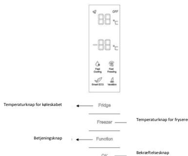
**TEMPERATURINDSTILLING:** Klik på knappen Fridge (Køleskab) eller Freezer (Fryser), og når symbolet blinker, kan temperaturen indstilles. Når knappen trykkes, ændres temperaturen tilsvarende. Temperaturer kan ikke indstilles under Fast cooling (hurtigkøling), Fast freezing (hurtigfrysning), Smart ECO og Vacation (ferie). Under temperaturindstilling, hvis der ikke trykkes på nogen knapper i 5 sekunder, holder knappen op med at blinke, og den indstillede temperatur træder i kraft.
