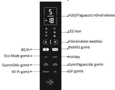
**BEÁLLÍTÓ gomb:** Nyomja meg a "SETTING" gombot a hőmérséklet módosításához.
