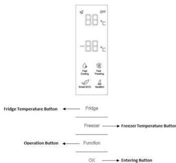
**POSTAVKE TEMPERATURE:** Pritisnite gumb „Fridge“ ili „Freezer“ i kada simbol zasvijetli, temperatura se može namjestiti. Temperatura se mijenja svakim pritiskom na gumb. Temperatura se ne može postaviti u okviru funkcija brzog hlađenja, brzog zamrzavanja, funkcije Smart ECO i funkcije godišnjeg odmora. Ako u okviru postavki temperature gumb nije u funkciji pet sekundi, prestaje svijetliti, a postavljena temperatura počinje se primjenjivati.
