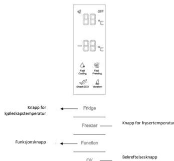
**TEMPERATURINNSTILLING:** Klikk på knappen «Fridge» (kjøleskap) eller «Freezer» (fryser), når lyset i symbolblikket blinker, kan temperaturen stilles inn. Hver gang knappen trykkes på, endres temperaturen. Temperaturene kan ikke stilles for funksjonene Fast Cooling (hurtigkjøling), Fast Freezing (hurtigfrysing), Smart ECO og Vacation (ferie). Hvis det ikke trykkes på en knapp innen 5 sekunder ved temperaturinnstilling, slutter knappen å blinke og den angitte temperaturen tas i bruk.
