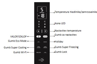
**Gumb SETTING:** Pritisnite gumb »SETTING«, da spremenite temperaturo.
