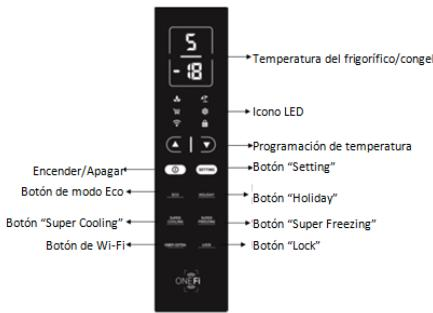
**Botón “Setting”:** Pulse “Setting” para cambiar la temperatura.
