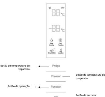
**AJUSTE DA TEMPERATURA:** Clique no botão "Fridge" ou "Freezer" e quando o símbolo estiver a piscar ajuste a temperatura. Cada vez que tocar no botão, a temperatura altera. As temperaturas não podem ser ajustadas nas Fast Cooling, Fast Freezing, Smart ECO e Holiday (refrigeração rápida, congelamento rápido, Smart ECO e férias). Durante o ajuste da temperatura, se o botão de operação não for tocado durante 5 segundos, o botão deixa de piscar e a temperatura atual no visor é assumida.
