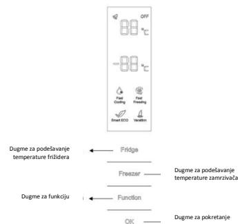
**PODEŠAVANJE TEMPERATURE:** Pritisnite dugme „Fridge“ ili „Freezer“ kada simbol zasveti, temperatura se može podešiti. Temperatura se menja u skladu sa svakim pritiskom na dugme. Temperatura se ne može podešavati u okviru funkcija brzog hlađenja, brzog zamrzavanja, funkcije Smart
