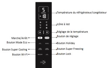
**Bouton de RÉGLAGE**: Appuyez sur « RÉGLAGE » pour modifier la température.
