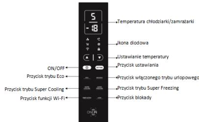
**Przycisk ustawień:** Naciśnij przycisk ustawień, aby zmienić temperaturę.
