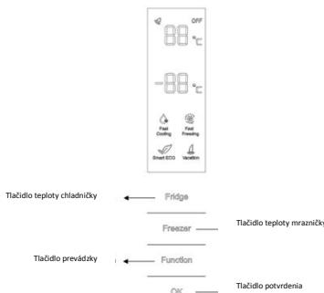
**NASTAVENIE TEPLOTY:** Kliknite na tlačidlo „Fridge“ alebo „Freezer“ a keď bude symbol blikať, je možné nastaviť teploty. Pri každom kliknutí na tlačidlo sa príslušným spôsobom zmení teplota. Teploty nie je možné nastaviť vo funkciách rýchleho chladenia, rýchleho mrazenia, Smart ECO a dovolenky. Ak sa pri nastavovaní teploty 5 sekúnd nevykoná žiadne ovládanie tlačidlami, tlačidlo prestane blikať a nastavená teplota sa použije.
