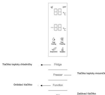
**NASTAVENÍ TEPLITY:** Klikněte na tlačítko „Fridge“ nebo „Freezer“ a když bude symbol blikat, budete moci nastavit teplotu. Po každém kliknutí na tlačítko se teplota změní odpovídajícím způsobem. Teploty nelze nastavit v rámci funkcí rychlého chlazení, rychlého mrazení, Smart ECO a dovolená. Pokud při nastavování teploty není během 5 sekund stisknuto žádné tlačítko, přestane tlačítko blikat a nastavená teplota je platná.
