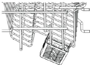
2. Jestliže zásobník na tablety 3 v 1 brání v otáčení ramene, otočte horním ostřikovacím rámennem jako na obrázku a pověste zásobník jinam.
