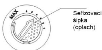
Dávkovač leštidla má šest nebo čtyř nastavení. Vždy začněte s dávkovačem nastaveným na "2". Jestliže jsou na nádobí skvrny, nebo je špatně usušené, zvýšte dávku leštidla sejmutím víčka dávkovače a otočením číselníku na "3". Jestliže jsou na nádobí stálé skvrny, nebo je špatně usušené, posuňte šipku na vyšší nastavení, dokud není nádobí bez skvrn. Doporučujeme nastavit leštidlo na hodnotu "4" (ve výrobě byla nastavena hodnota "4").
