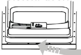
Okraje dveří čistěte jen měkkým hadříkem namočeným v teplé vodě. Nepoužívejte žádné čisticí spreje, aby se voda nedostala do zámku dveří a elektrických komponentů. Nepoužívejte drsné čisticí prostředky nebo drátěnky k čištění vnějších ploch, mohly by poškrábat povrch. Poškrábat povrch nebo na něm zanechat stopy mohou i některé papírové utěrky.
