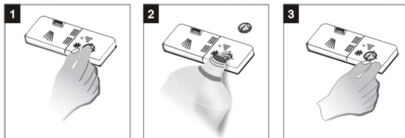
1 Dávkovač otevřete otočením víčka do polohy šipky "otevřeno" (vlevo) a zdvihnutím.
