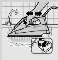
**4** Állítsa a hőmérsékletet a MAX jelzésig.**5** Csatlakoztassa a hálózati dugót földelt fali konnektorba.**6** Amikor a hőmérsékletjelző fény elalszik, húzza ki a hálózati dugót a fali konnektorból.**7** Tartsa a vasalót a mosogató fölé, és a vízkőmentesítő gombot (Calc-Clean) nyomva tartva óvatosan rágogassa a készüléket.
