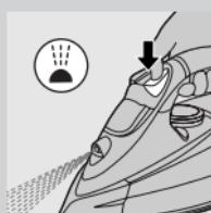
Pro navlhčení oděvu k žehlení můžete při jakékoliv teplotě použít funkci rozprašovače. Ta pomáhá odstranit nepoddajné záhyby.
