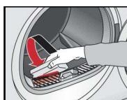
2. Vyčistěte čidla vlhkosti vlhkou houbou s drsným povrchem.
