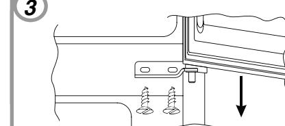
Draai de twee schroeven aan de achterzijde van de deur los en verwijder de bovenzijde.
