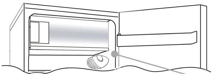
La caja del termostato que controla la aplicación se encuentra ubicada dentro del compartimento del frigorífico en la zona superior derecha. Para comprobar si la aplicación está funcionando, asegúrese de que la rueda del termostato no esté fijada en "0".
