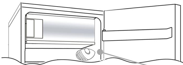
Le thermostat commandant l'appareil se trouve en haut à droite à l'intérieur du réfrigérateur. Pour vérifier que l'appareil fonctionne, assurez-vous que le bouton du thermostat ne se trouve pas en position OFF.
