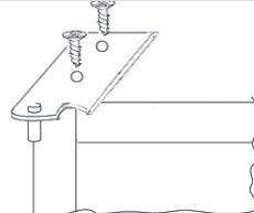
Verwijder de plug aan de linkerzijde en plaats deze aan de rechterzijde.
