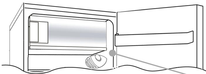
Termostatboksen som kontrollerer apparatet befinner seg opp til høyre i kjøledelen. For å kontrollere at apparatet virker, må du sjekke at termstatens bryter ikke står på „0“.
