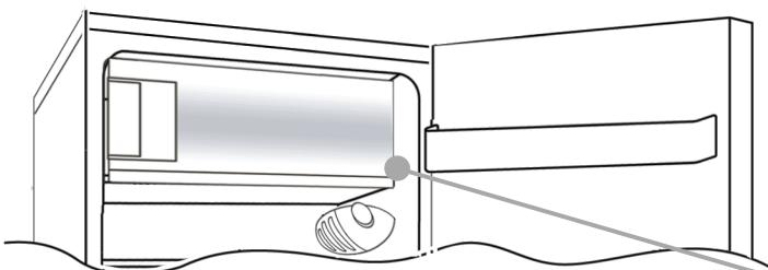
Термостат, с помощью которого задается нужная температура в холодильнике, расположен внутри холодильной камеры (в правом верхнем углу). Чтобы проверить, что холодильник работает, убедитесь в том, что ручка терmostата не установлен в положение "0".
