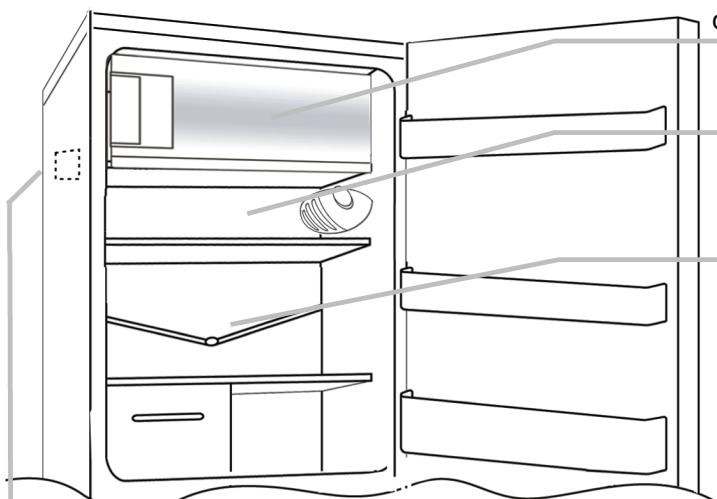
Рекомендуется выполнять размораживание морозильной камеры, когда на стенах морозильной камеры нарастает слой инея толщиной более 3 мм.
