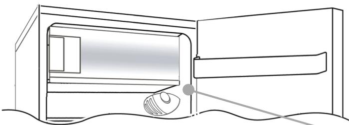
Den termostatboks, der styrer temperaturen i skabet, sidder indvendig i køleafdelingen foroven til højre. Når det kontrolleres, om skabet fungerer, skal det sikres, at termostatknappen ikke står på „0“.
