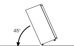
Verwijder het onderste scharnier door de schroeven, plug en sluitringen los te draaien.
