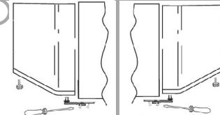
Vegye le a két felső csavarvédőt, és csavarozza ki a két felső csavart.
