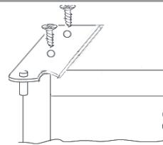
Quite la clavija de la parte izquierda e intodúzcala en la parte derecha de la hendidura central e inferior.
