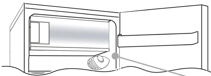
Die Thermostatbox zur Steuerung des Gerätes befindet sich oben rechts im Inneren des Kühlraums. Um zu prüfen, ob das Gerät in Betrieb ist, stellen Sie sicher, dass der Thermostatkopf nicht auf **ON** gestellt ist.
