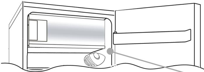
Το κουτί θερμοστάτη για τον έλεγχο της συσκευής βρίσκεται στο εσωτερικό του χώρου συντήρησης στο πάνω δεξιό μέρος. Για να ελέγξετε αν η συσκευή λειτουργεί, βεβαιωθείτε ότι το κουμπί του θερμοστάτη δεν έχει ρυθμιστεί στο „0“.
