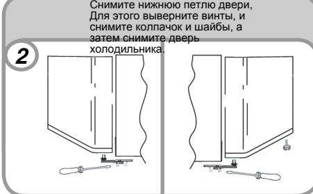
Снимите нижнюю петлю двери. Для этого выверните винты, и снимите колпачок и шайбы, а затем снимите дверь холодильника.
