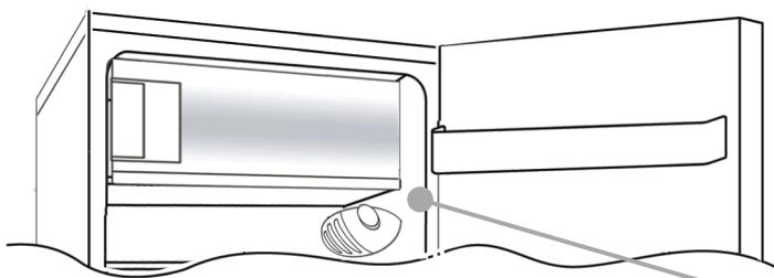
A caixa do termóstato que controla o equipamento está localizada dentro do compartimento do frigorífico no lado superior direito. Para verificar se o equipamento está a funcionar, certifique-se de que o botão do termostato não está regulado para „0“.
