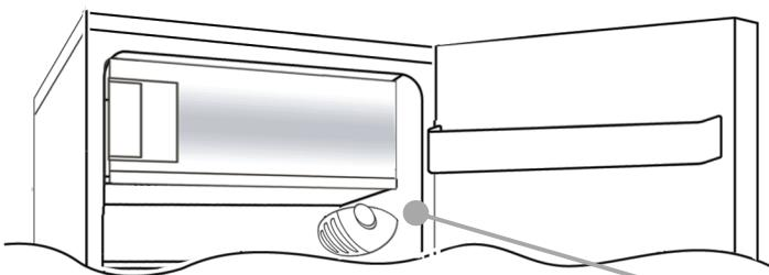
La scatola termostato per il controllo dell'apparecchio è collocata all'interno della cella frigo in alto a destra. Per essere certi che l'apparecchio stia funzionando accertarsi che la manopola termostato non sia sulla posizione OFF.
