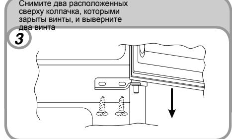
Снимите два расположенных сверху колпачка, которыми зарыты винты, и выверните два винта
