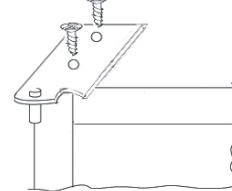
Retirez le cache du côté gauche et insérez-le dans les inserts du milieu et du bas sur le côté droit.
