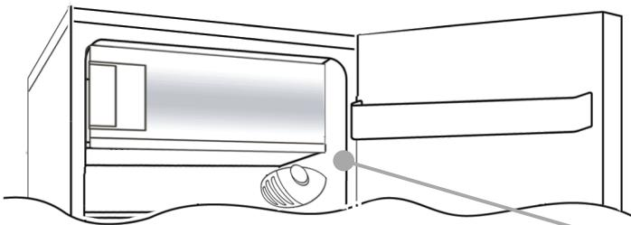
Laitteen säätöön tarkoitettu termostaattilaatikko sijaitsee jääräappiosaston sisällä oikealla ylhäällä. Kun haluat tarkastaa, että laite toimii, varmista, että termostaattinuppi ei ole asennossa "0".
