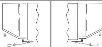
Entfernen Sie die mittlere Schraube und entfernen Sie die obere Tür.
