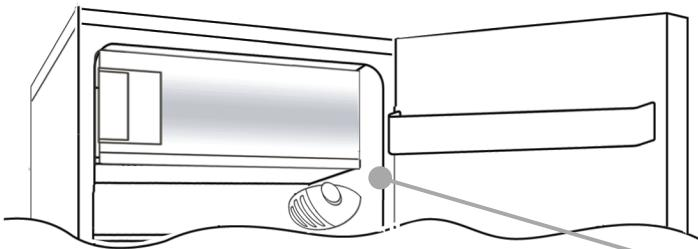
De thermostaatregelaar van het apparaat bevindt zich rechtsboven in het koelkastgedeelte. Om te controleren of het apparaat functioneert dient u erop te letten dat de knop van de thermostaat niet op „0“ staat.
