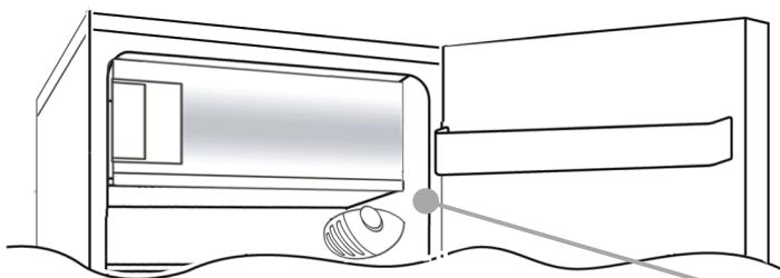
Termostat určený k ovládání spotřebiče je umístěný uvnitř chladničky vpravo nahore. Pokud chcete zkontrolovat, že zařízení opravdu funguje, přesvědčete se, že termostat není nastavený v poloze „0“.
