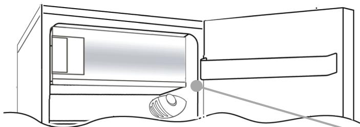
De thermostaat van het apparaat bevindt zich rechtsboven in het koelgedeelte. U kunt alleen controleren of het apparaat werkt als de thermostaatknop niet op 0 staat.
