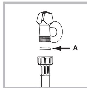
1. Vložte tesnenie A do koncovej časti prítokovej hadice a pripevnite ju k uzáveru studenej vody so závitom 3/4" (vid' obrázok). Pred pripojením hadice nechajte vodu odtiecť, až kým nebude priezračná.
