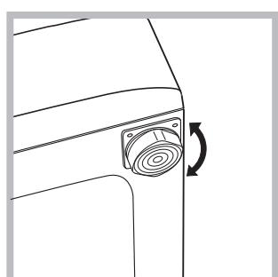
2. Yerleştirilecek zemin tam düz değilse çamaşır makinesinin vidalı ön ayaklarını sıkı ve gevşeterek dengeyi sağlayınız (*bkz. şekil*); eğim açısı, makinenin üst tezgahına göre  $2^{\circ}$  den fazla olmamalıdır.
