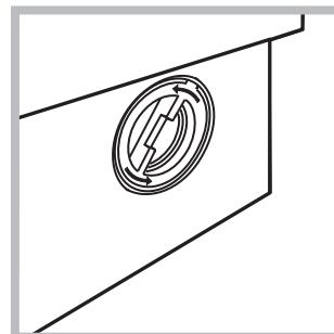
2. odskrutkujte veko otáčaním proti smeru hodinových ručičiek (*viď obrázok*): vyečenie malého množstva vody je úplne bežným javom;
