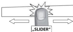
Pro vypnutí plotýnky posuňte prstem po zóně výběru výkonu, dokud se na displeji nezobrazí 0 nebo H.
