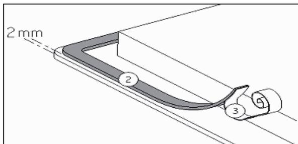
Do vyříznutého otvoru v pracovní desce vložte varnou desku.
