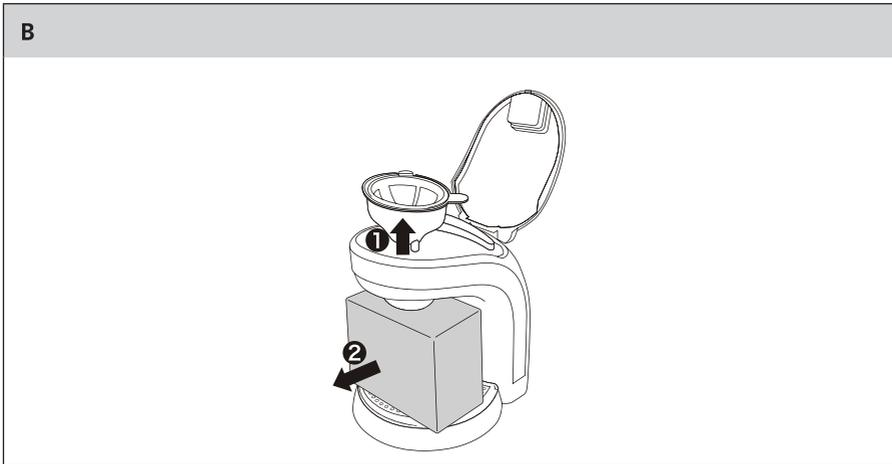
2. Permanentní filtr A⑤ a držák filtru A④ důkladně omyjte v teplé vodě za použití kuchyňského saponátu. Pak tyto části opláchněte pod čistou tekoucí vodou a osušte.
