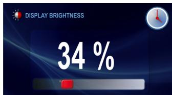
Navigačnými tlačidlami mi  $\swarrow$   $\nwarrow$  meníme jas displeja v rozsahu 0-100% s presnosťou 1%. Nastavená úroveň jasu displeja potvrdzujeme tlačidlom OK.
