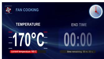
Po premietnutiu pracovnej obrazovky bliká 5 sekúnd symbol a v tomto čase je možná zmena implicitnej teploty na ľubovoľnou inou, zákazníkom požadovanou teplotu v rozsahu uvedenom v tabuľke. Zmenu vykonávame tlačidlami  $\swarrow$   $\nwarrow$ . Po uplynutí 5 sekúnd od vykonania poslednej zmeny teploty alebo po skorším stlačení tlačidla OK aktuálne premietaná teplota je zapísaná do programátora a bliká symbol .
