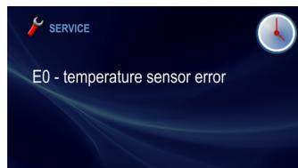
V případě odhalení pomocí elektroniky jedné z definovaných chyb, bude tato promítnutá na obrazovce, jak je výše uvedené
