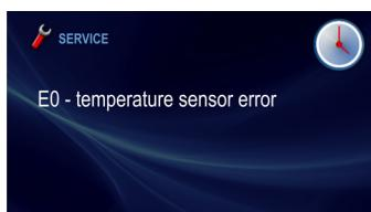
V prípade odhalení pomocí elektroniky jednej z definovaných chýb, bude tato premietnutá na obrazovke, ako je hore uvedené.
