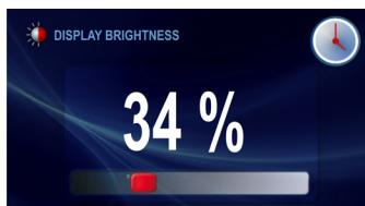
Navigačními tlačítky  $\swarrow$   $\nwarrow$  měníme jasnost displeje v rozsahu 0-100% s přesností 1%. Nastavená úroveň jasnosti displeje potvrzuje tlačítkem OK.
