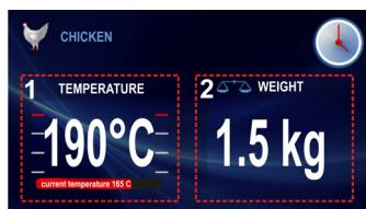
Blikající symbol váhy, informuje, že je možné provést změnu váhy na požadovanou základníkem anebo potvrdit navrhovanou váhu implicitně. Jestliže v průběhu 3 min od promítání pracovní obrazovky nebude provedený jakýkoliv úkon, to programátor přechází do stavu bdění.
