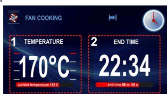
Jestliže v průběhu 5 sekund nebude zavedena žádná změna, displej se vrátí do promítání pouze nastavené a aktuální teploty, jak rovněž se ztratí okno 2 a přestane blikat symbol  $\rightarrow$ .
