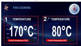
Od momentu vložení pečící sondy do zásuvky bliká 5 sekund symbol . Jestliže v průběhu 5 sekund nebude do programátoru zavedená žádná změna, bude ponechaná zavedená aktuální teplota pro pečící sondy.
