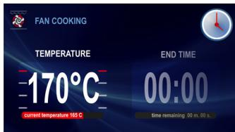
Po promítnutí pracovní obrazovky bliká 5 sekund symbol a v tomto čase je možná změna implicitní teploty na libovolnou jinou, zákazníkem požadovanou teplotu v rozsahu uvedeném v tabulce. Změnu provádíme tlačítky  $\swarrow$   $\nwarrow$ . Po uplynutí 5 sekund od provedení poslední změny teploty anebo po dřívějším stlačení tlačítka OK aktuálně promítaná teplota je zapsaná do programátoru a bliká symbol .
