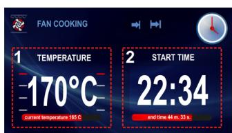
Jestliže v průběhu 5 sekund nebude zavedena žádná změna, programátor se vrátí k dříve vykonávané nastavené činnosti - cíli do práce s nastaveným časem práce a zvolenou funkcí ohrevu. Změny nastavení hodiny zakončení času práce se uskutečňují s použitím navigačních tlačítek ▼ ▲ s přesností 1 minuty. Po 5 sekundách anebo po dřívějším stlačení tlačítka OK je nastavený konec času práce zapsaný do paměti programátoru.
