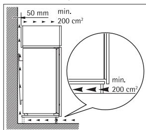
Vyrovnejte spotřebič pomocí nastavitelných noh, zajistěte mezeru mezi spodním okrajem spotřebiče a zemí, aby byla zajištěna cirkulace chladicího vzduchu, čímž zajistíte optimální výkon chladicího okruhu.
