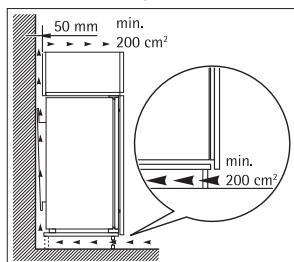
Vyrovnejte spotrebič pomocou nastaviteľných nôh, zaistite medzeru medzi spodným okrajom spotrebiča a zemou, aby bola zaistená cirkulácia chladiaceho vzduchu, čím zaistíte optimálny výkon chladiaceho okruhu.
