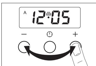
Ked' spotrebič pripojíte k elektrickému napájaniu alebo po výpadku napájacieho napäťa, začne displej automaticky blikať.
