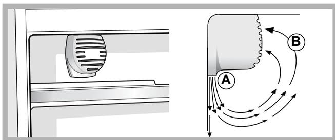
Poate fi ușor recunoscut datorită prezenței, în partea de sus a frigiderului, a dispozitivului indicat (vezi figura). Sistemul de răcire permite conservarea optimală a alimentelor deoarece aduce temperatura la nivelul optimal în mod rapid (de exemplu după deschiderea ușii) și distribuie temperatura în mod omogen: aerul suflat (A) se răcește când intră în contact cu pereții reci, iar aerul mai cald (B) este aspirat (vezi figura).
