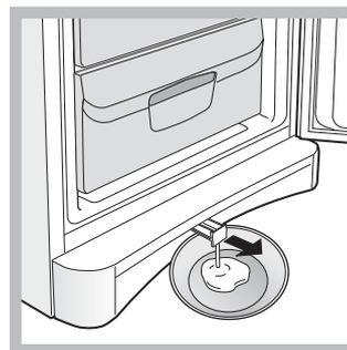
SISTEMA DRAIN care dirijează apa spre exterior. Introduceți răzuitorul din dotare în fisura din partea de jos a congelatorului și așezați un recipient (vezi figura) pentru a recolta apa eliminată.
