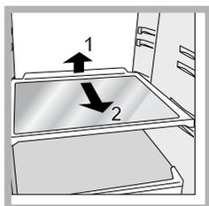
Sunt detașabile și reglabile în înălțime mulțumită ghidajelor (vezi *figura*), utile pentru susținerea recipientelor sau a alimentelor de dimensiuni mari. Reglarea înălțimii la care sunt dispuse se poate face și fără a extrage raftul întreg.
