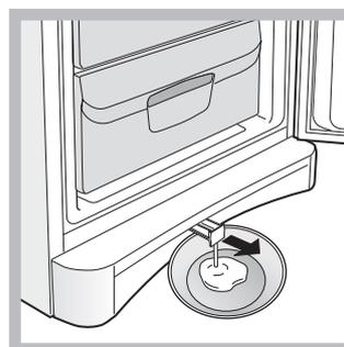
5. Některá zařízení jsou vybavena DRENÁŽNÍM SYSTÉMEM sloužícím k odvádění vody směrem ven: nechte vodu odtékat do nachystané nádoby (viz obrázek).
