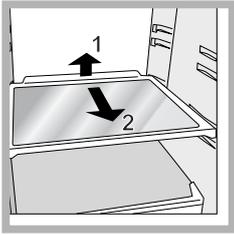
**POLICE:** plné nebo ve formě mřížky. Jsou vyjímatelné a výškově nastavitelné prostřednictvím příslušných vodicích drážek (viz obrázek), sloužících k zasunutí prostorných nádob nebo potravin. Nastavení výšky nevyžaduje úplné vytažení police.
