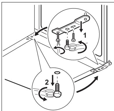
Vyšroubujte obě seřiditelné nožičky a šrouby dolního dveřního závěsu. Odstraňte dolní dveřní závés a instalujte ho na opačné straně.
