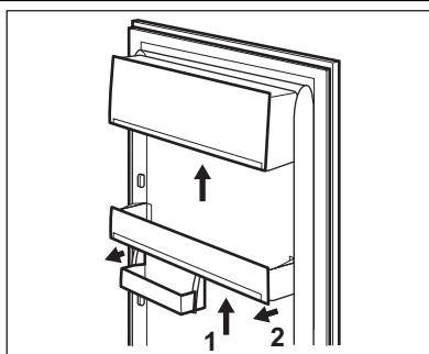
Dveřní police můžete umístit do různé výšky a vkládat tak do nich různě velká balení potravin. Tyto úpravy provedete následujícím způsobem: pomalu posuňte polici ve směru šipek, dokud se neuvolní, a pak ji zasuňte do zvolené polohy.
