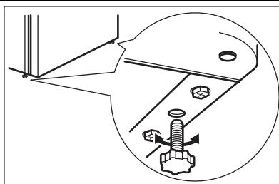
W trakcie ustawiania urządzenia należy zwrócić uwagę, aby było ono prawidłowo wypoziomowane. Służą do tego dwie regulowane przednie nóżki.
