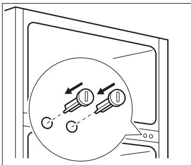
Na opačnej strane nainštalujte kryty otvorov. Utiahnite záves. Skontrolujte, či sú dvere vyrovnané.
