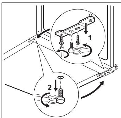
Odkręcić obie regulowane nóżki oraz śruby do innego zawiasu drzwi. Zdjąć dolny zawias drzwi i zamocować go po przeciwej stronie.
