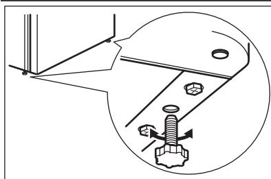
Pri umiestňovaní spotrebiča dbajte na to, aby bol vyrovnaný do vodorovnej polohy. Vyrovnanie do vodorovnej polohy je možné dosiahnuť pomocou dvoch nastaviteľných nožičiek vpred v dolnej časti spotrebiča.
