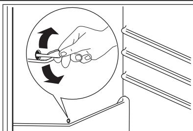
Podczas normalnego użytkowania, za każdym razem po wyłączeniu się silnika sprężarki, następuje automatyczne usunięcie szronu z parownika komory chłodziarki. Woda z rozpuszczonego szronu spływa rynienką do specjalnego pojemnika znajdującego się z tyłu urządzenia nad sprężarką, skąd następnie odparowuje.
