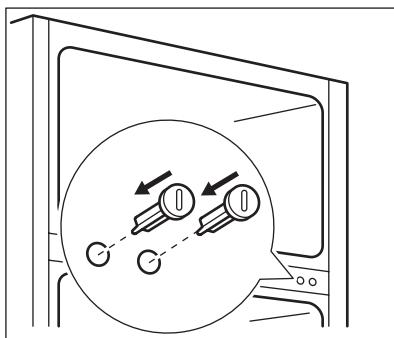
Na opačné straně nasaděte krytky otvorů. Utáhněte závés. Přesvědčte se, že jsou dveře dobře vyrovnané.
