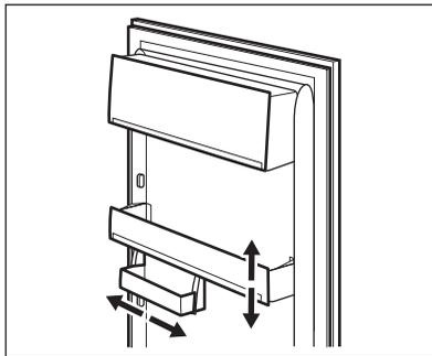
Die Türablagen können in unterschiedlicher Höhe positioniert werden, womit das Lagern verschieden großer Lebensmittelpackungen ermöglicht wird. Nehmen Sie die Einstellungen wie folgt vor: Ziehen Sie den Einsatz langsam in Pfeilrichtung, bis er sich herausheben lässt, und setzen Sie ihn dann an der gewünschten Position wieder ein.
