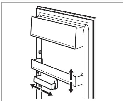
Dveřní police můžete umístit do různé výšky a vkládat tak do nich různě velká balení potravin. Tyto úpravy provedete následujícím způsobem: pomalu posunujete polici ve směru šipek, dokud se neuvolní, a pak ji zasuňte do zvolené polohy.
