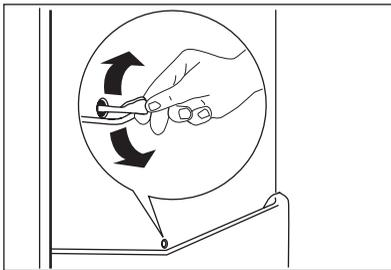
Během normálního používání se námraza automaticky odstraňuje z výparníku chladicího oddílu při každém vypnutí motoru kompresoru. Rozmrazená voda vytéká žlábkem do speciální nádoby na zadní straně spotřebiče nad motorem kompresoru, kde se odpařuje.
