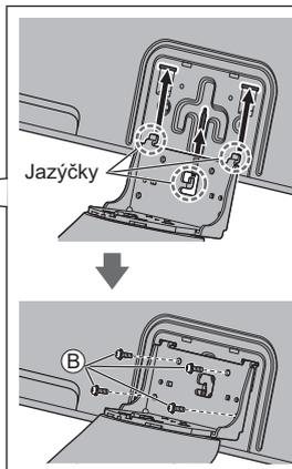
Vyrovnejte 3 jazýčky na držáku s drážkami na zadní straně televizoru a zasuňte je. Ujistěte se, že je prostřední jazýček zastrčen v otvoru televizoru. Zasuňte držák tak, aby byly šipky (↓↑) na televizoru a držáku vyrovnány.
