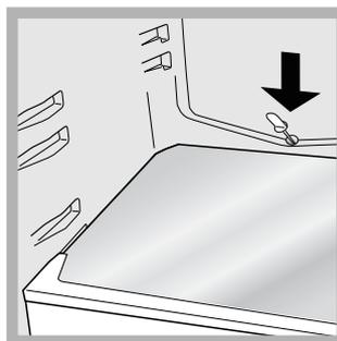
A hűtőszekrény automatikus dértelenítő rendszerrel van ellátva: a víz egy arra alkalmas levezető nyíláson keresztül a hátsó részek felé vezetődik (lásd ábra), ahol a kompresszor által termelt hő elpárologtatja. Az egyetlen beavatkozás, amit rendszeresen el kell
