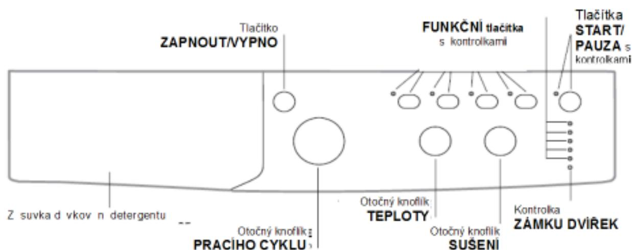
Z suvka d vkov n detergentu: se používá k dávkování detergentů a pracích přísad (viz „Detergenty a prádlo“).
