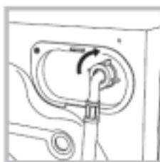
2. Přívodní hadici napojte na pračku jejím našroubováním na odpovídající nátrubek přívodu vody, který je umístěn nahoře na pravé straně zadní části zařízení (viz obrázek).
