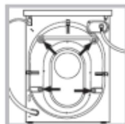
3. Odmontujte 3 ochranné šrouby (používané při přepravě) a gumovou podložku s odpovídající rozpěrkou umístěnou v zadní části zařízení (viz obrázek).
