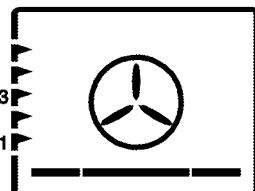
Funguje dolní ohřev a topní kruh s ventilátorem (v zadní stěně). Vhodné pro pečení pizzy.
