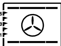
Horní, dolní ohřev plus kruhový ohřev s ventilátorem (v zadní stěně) jsou zapnuty. Pečený pokrm je rovnoměrně a rychle upečen po celém obvodu. Používejte vždy jen jeden plech.
