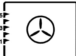
Teplý vzduch zahřívaný zadním prvkem se rovnoměrně rozvádí po celé troubě velmi rychle pomocí ventilátoru. Hodí se na ohřívání vašich pokrmů na různých úrovních polic, ve většině případů není nutné troubu předehřívat. Vhodné pro použití více plechů.
