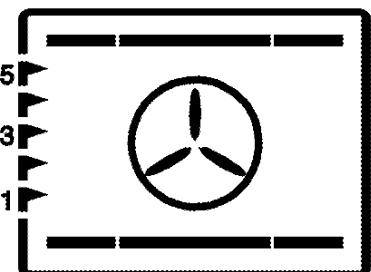
Horní, dolní ohřev plus kruhový ohřev s ventilátorem (v zadní stěně) jsou zapnuty. Pečený pokrm je rovnoměrně a rychle upečen po celém obvodu.
