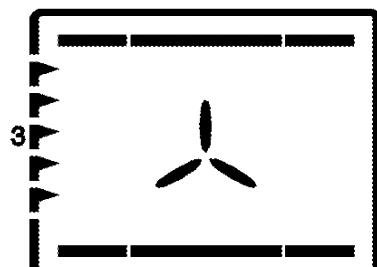
Teplý vzduch zahřívaný horními a dolními prvky se rovnoměrně rozvádí po celé troubě velmi rychle pomocí ventilátoru. Používejte vždy jen jeden plech.
