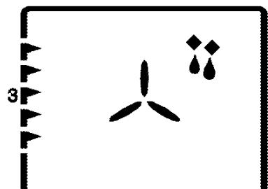
Trouba se nezahřívá. Funguje pouze ventilátor (v zadní stěně). Zmražené potraviny se rozmrazuje pomalu při pokojové teplotě, upečené potraviny se ochladí.
