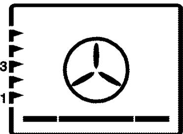
Funguje dolní ohřev a topný kruh s ventilátorem (v zadní stěně). Vhodné pro pečení pizzy.
