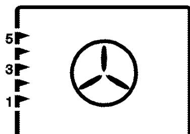
Teplý vzduch zahřívaný zadním prvkem se rovnoměrně rozvádí po celé troubě velmi rychle pomocí ventilátoru. Hodí se na ohřívání vašich pokrmů na různých úrovních polic, ve většině
