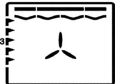
Teplý vzduch zahřívaný velkým grilem se rovnoměrně rozvádí v troubě velmi rychle pomocí ventilátoru. Hodí se na grilování velkého množství masa.
