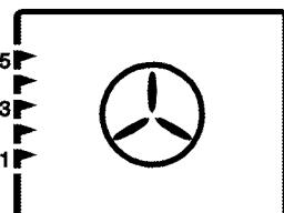
Teplý vzduch zahřívaný zadním prvkem se rovnoměrně rozvádí po celé troubě velmi rychle pomocí ventilátoru. Hodí se na ohřívání vašich pokrmů na různých úrovních polic, ve většině
