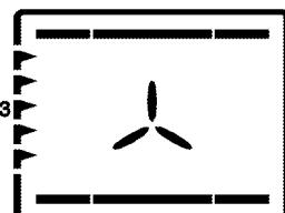
Teplý vzduch zahřívaný horními a dolními prvky se rovnoměrně rozvádí po celé troubě velmi rychle pomocí ventilátoru. Používejte vždy jen jeden plech.
