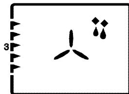
Trouba se nezahřívá. Funguje pouze ventilátor (v zadní stěně). Zmrzařené potraviny se rozmrazuje pomalu při pokojové teplotě, upečené potraviny se ochladí.
