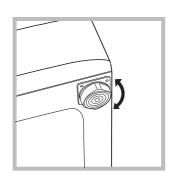
2. Якщо підлога не є ідеально горизонтальною, компенсуйте нерівності за допомогою передніх ніжок (див. малюнок) — розкручуючи чи закручуючи їх; кут нахилу відносно робочої поверхні не повинен перевищувати 2°.
